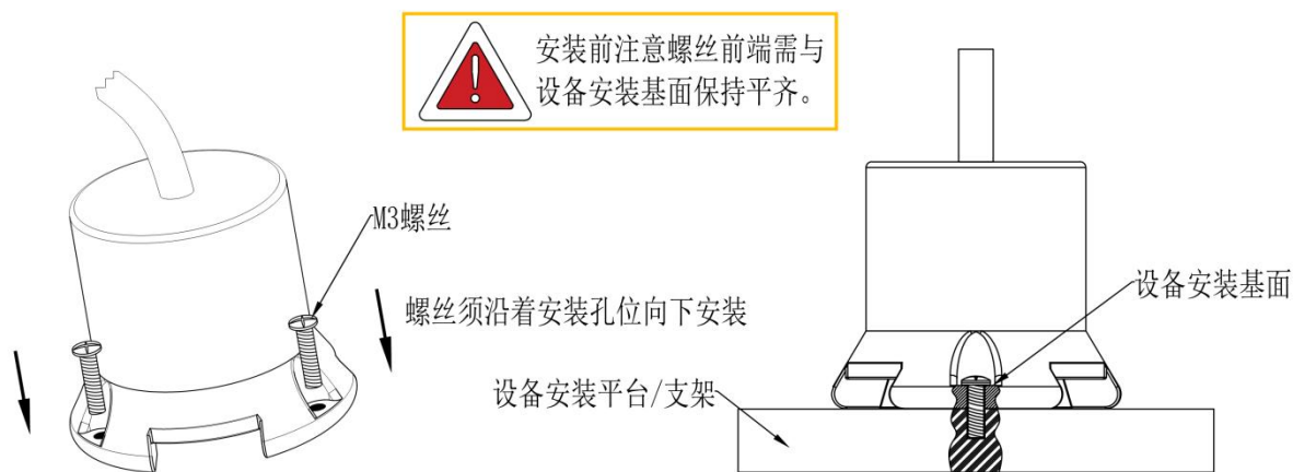
图 4 螺丝安装示意图
