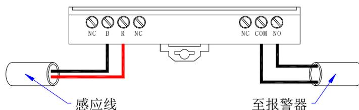
图 6 感应线与继电器连接示意图
