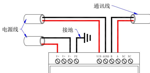
图 5 电源线与通信线连接示意图
