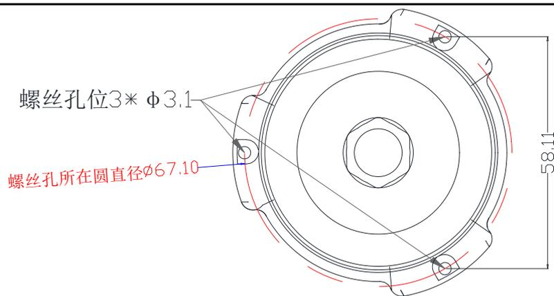
图 5 安装尺寸图
